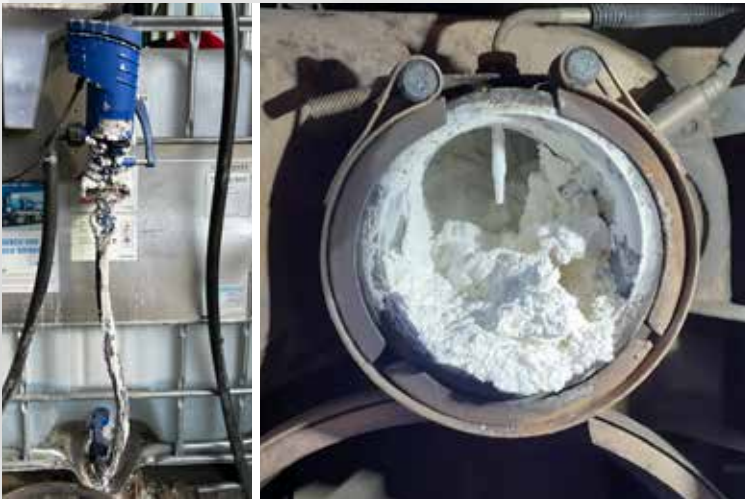
Problemas en el sistema de AdBlue® debido a la formación de depósitos. Protección del sistema SCR: "El aditivo para el aditivo"
